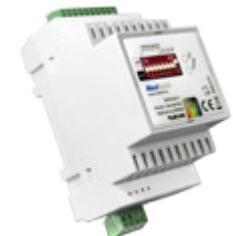
MODUŁ STEROWNIKA RGB+W 2X (PWM) TUKAN NXW224.5
