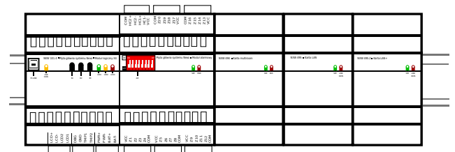
Rys. 4.7. Sposób podłączenia kart rozszerzeń do centrali systemu
